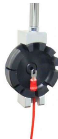
Wiretest 2 Contrôle automatisé jusque 5kN
