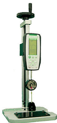
Wiretest I et TI - Vérification manuelle simple des câbles et cosses
